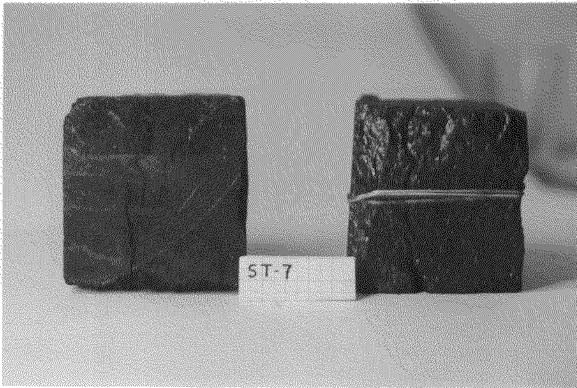
Fig. 15.- Probetas cúbicas (7x7x7 cm) (15W) utilizadas para obtener V_L . Obsérvense las fracturas verticales.
