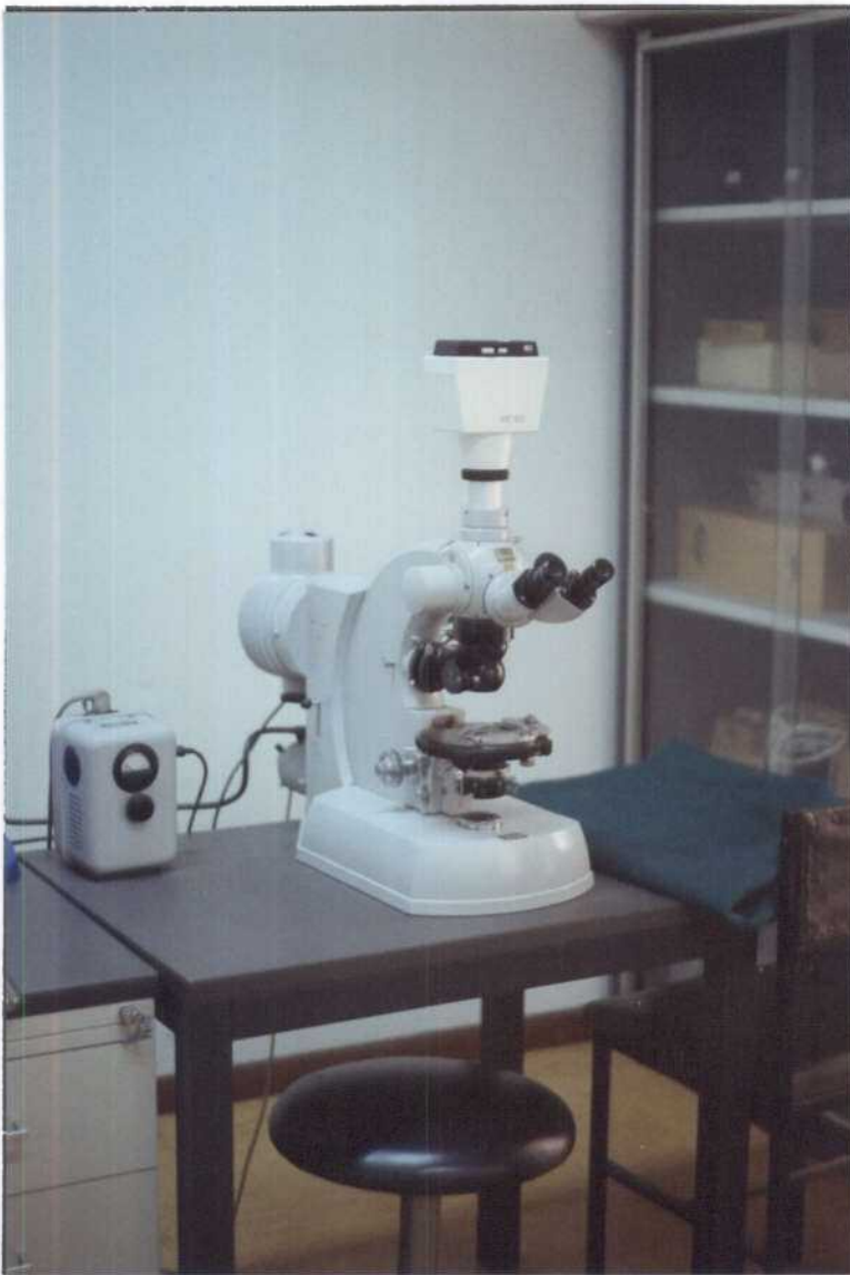
Figs. 1 y 2 : Microscopio óptico de fluorescencia por reflexión. Muestras de carbones impregnadas con resinas epoxídicas teñidas con colorantes para resaltar su microfisuración.
